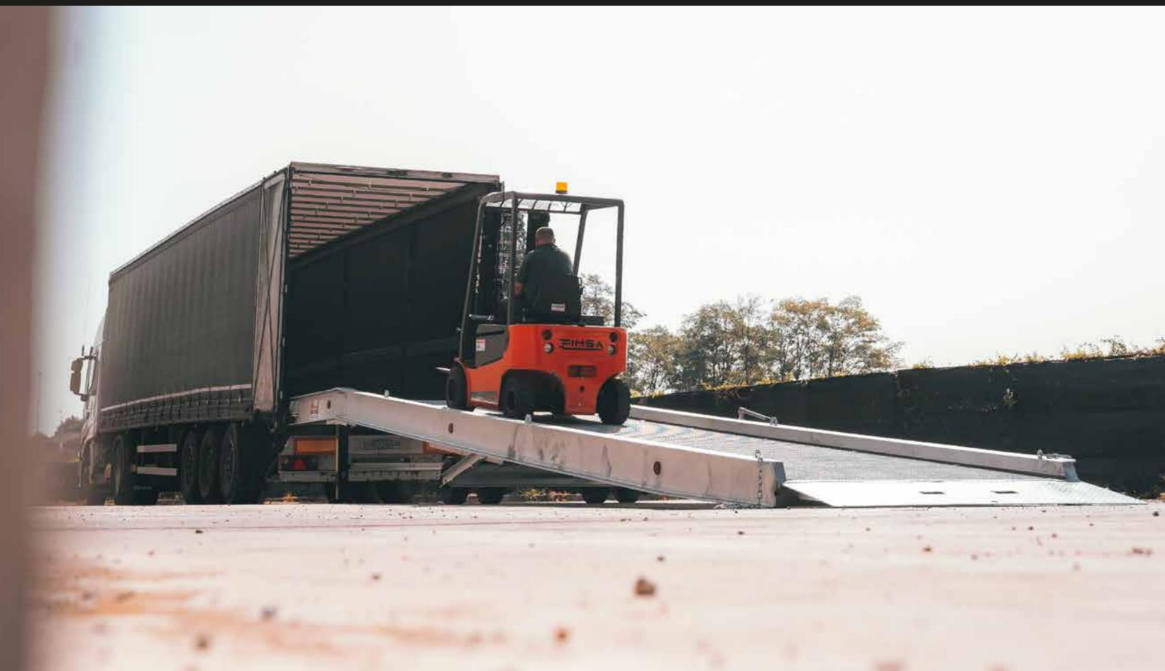
Paracarrelli laterali di protezione posti ai due lati del piano carrabile di altezza tot. 120 mm circa.
